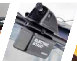
El. start s vlastním dobíjením za chodu motoru
